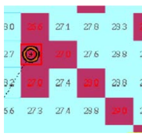
Placement d'une marque sur la sonde douteuse
