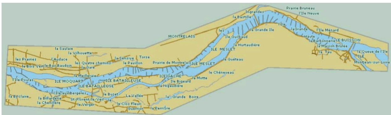
Vue du fichier DXF converti au format S-57 (avec remplissage des surfaces)
